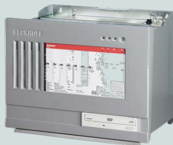
C61xx | ПК для шкафов управления
