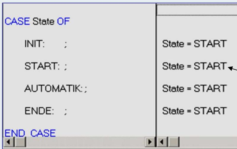
Если целочисленная переменная state объявлена перечисляемым типом, в online режиме она видна в виде текста.
